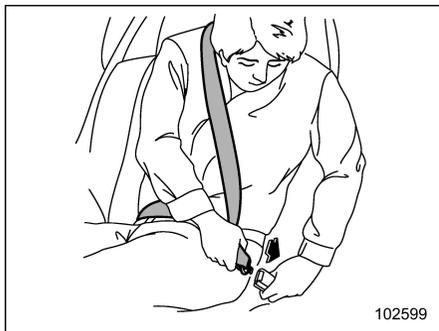
5. Introduisez la languette de la ceinture de sécurité centrale dans la boucle correspondante jusqu'à entendre un clic.
