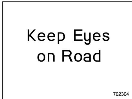
Lorsque le système détecte que le conducteur peut être inattentif, il l'avertit. Lorsque l'avertissement de conduite inattentive s'active, l'avertisseur sonore retentit et un écran d'interruption apparaît sur l'affichage des instruments de bord (écran LCD en couleur).
