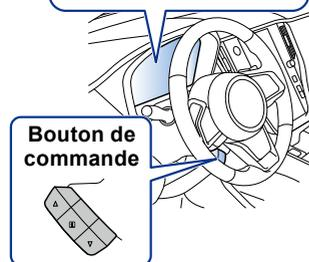
**Bouton de commande :** Les flèches ▲ ou ▼ du bouton de commande permettent de permuter les écrans. Lorsque le commutateur **i** est tiré vers vous, le message marqué du symbole **i** à l'écran sera rappelé.
