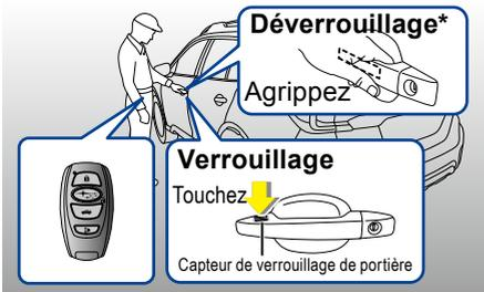
\*Agrippez la poignée de la portière du conducteur pour déverrouiller la portière du conducteur et le volet du réservoir de carburant. Agrippez la poignée de la portière du passager avant pour déverrouiller toutes les portières et le volet du réservoir de carburant.
