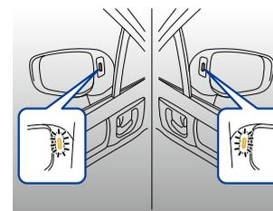
Le système BSD/RCTA comprend des radars aux angles arrière avec surveillance d'angles morts et avertissement de circulation transversale arrière. Ces fonctions permettent au système de détecter la présence d'objets ou de véhicules à l'arrière et attirant l'attention du conducteur lors de changements de voie ou de manœuvres en marche arrière.
