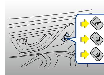
Il est possible de conserver en mémoire certains réglages de position du siège et des rétroviseurs extérieurs. Enregistrez en mémoire les réglages de position du siège et des rétroviseurs extérieurs en appuyant sur le bouton 1 ou 2, ou sur chacune des manettes d'accès pour ensuite retrouver la position désirée.
