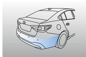
Le système détecte les objets au moyen de capteurs sonars installés dans le pare-chocs arrière.
