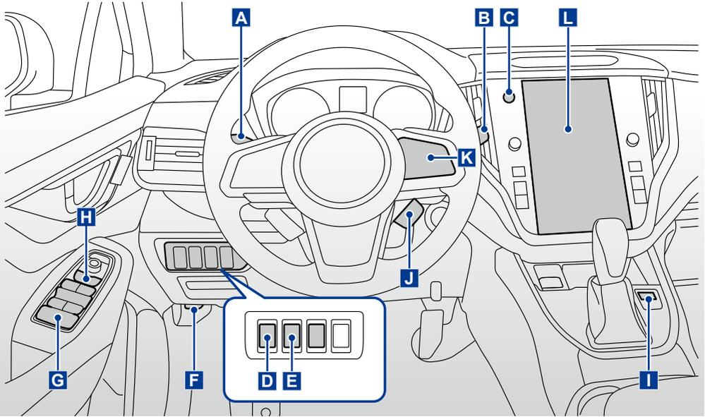
**A** Interrupteur de phares / manette des clignotants / interrupteur d'antibrouillards
