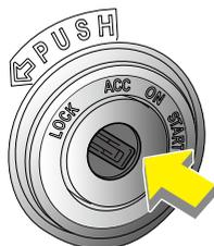
Il est uniquement possible de tourner la clé de la position **ACC** à la position **LOCK** lorsqu'on enfonce la clé en tournant et tandis que le levier sélecteur est à la position **P** (modèles à boîte CVT).
