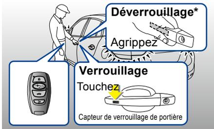
\*Agrippez la poignée de la portière du conducteur pour la déverrouiller. Agrippez la poignée de la portière du passager avant pour déverrouiller toutes les portières et le hayon.
