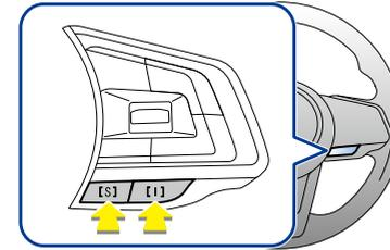
Le système SI-DRIVE comporte deux modes : Intelligent (I), Sport (S). Lorsqu'il est activé, le système SI-DRIVE agit sur les paramètres du moteur.
