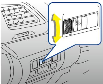
Pour régler l'intensité lumineuse du panneau d'instruments, tournez la molette.
