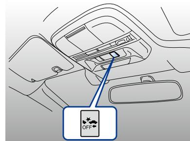
Maintenez la touche enfoncée pendant deux secondes ou plus pour désactiver le système de freinage précollision (ainsi que l'assistance au freinage précollision).
