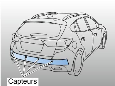
Le freinage automatique en marche arrière (RAB) est une technologie conçue pour aider à éviter les collisions, ou à diminuer l'ampleur des dommages, lorsque le conducteur manœuvre en marche arrière. Si un mur ou un obstacle est détecté dans la trajectoire de marche arrière, le système alerte le conducteur au moyen d'un signal sonore et peut actionner les freins automatiquement.
