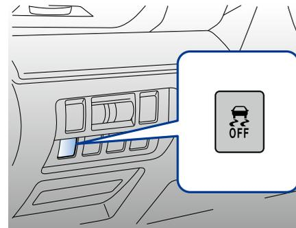
Si l'interrupteur est enfoncé, le voyant de désactivation du VDC (contrôle de la dynamique du véhicule) s'affiche dans le groupe d'instruments et le système de contrôle de la dynamique du véhicule est désactivé.
