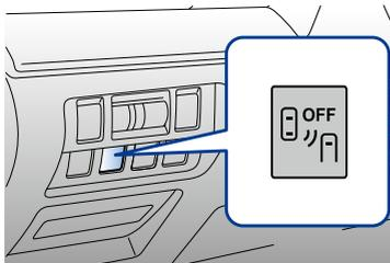
Si l'interrupteur est enfoncé, le voyant de désactivation BSD/RCTA OFF s'affiche dans le groupe d'instruments et le système BSD/RCTA est désactivé.
