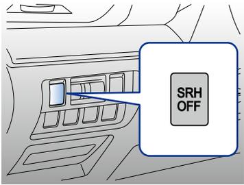
Si l'interrupteur est enfoncé, le voyant SRH OFF s'affiche dans le groupe d'instruments, et le système de phares directionnels est désactivé.
