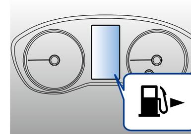
Cette icône indique que le volet du réservoir de carburant est situé du côté droit du véhicule.
