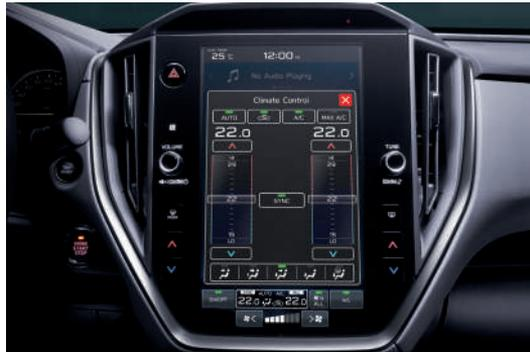
Contrôle de température automatique à deux zones
