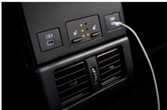
Ports USB-C et sièges chauffants<sup>1</sup> aux places latérales arrière
