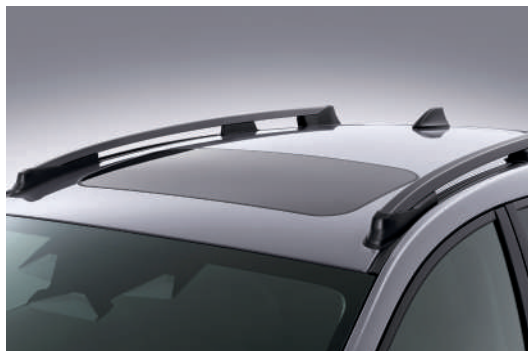
Toit ouvrant vitré électrique 4 et longerons de toit
